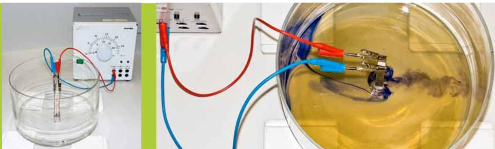
Hier wird blau gefärbtes Wasser von links nach rechts gepumpt. Dies geschieht mit Hilfe von elektrischem Strom und einem Magneten, aber ohne eine Pumpe zu verwenden.
